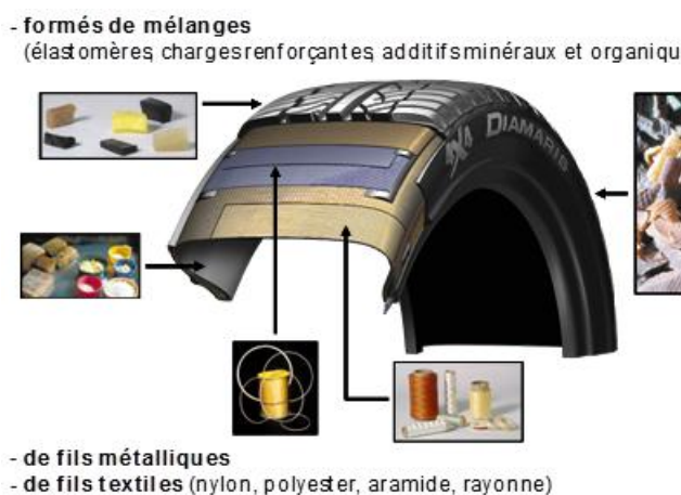
Figure 1 : Description d'un pneumatique Gamme Tourisme
