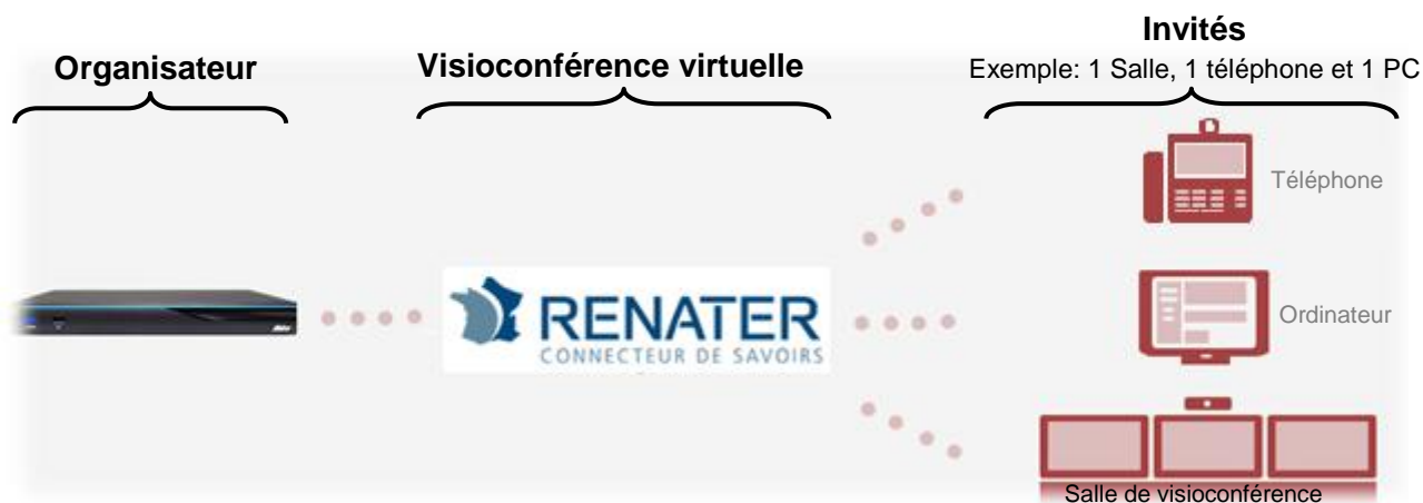
Figure 9: Fonctionnement du système de visioconférence avec Renater (Exemple avec 4 participants)
