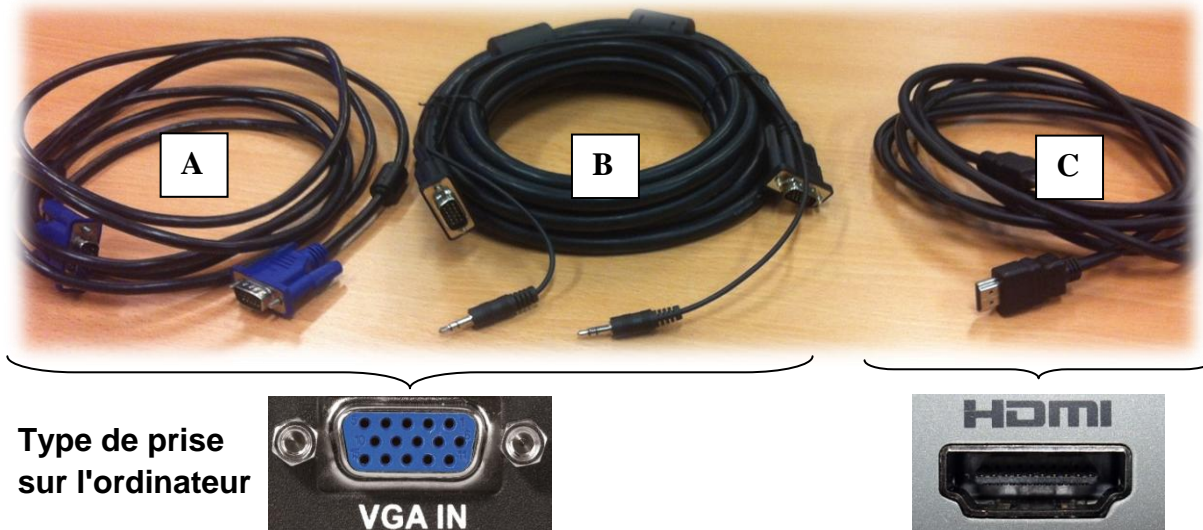
Figure 3: Les câbles mis à disposition. A : câble VGA; B : câble VGA avec audio; C : câble HDMI
